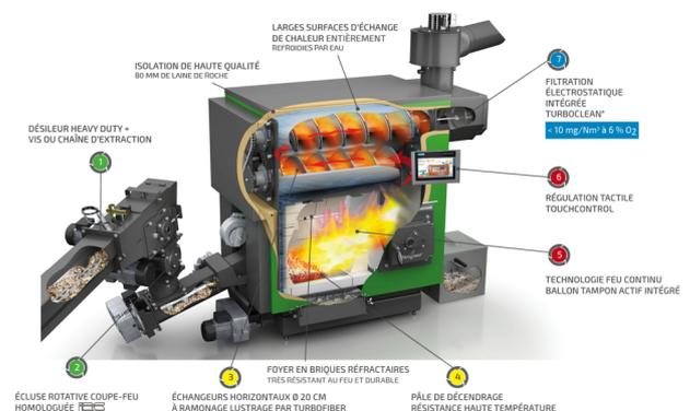
Principe d'une chaudière à bois déchiquetés et granulés
